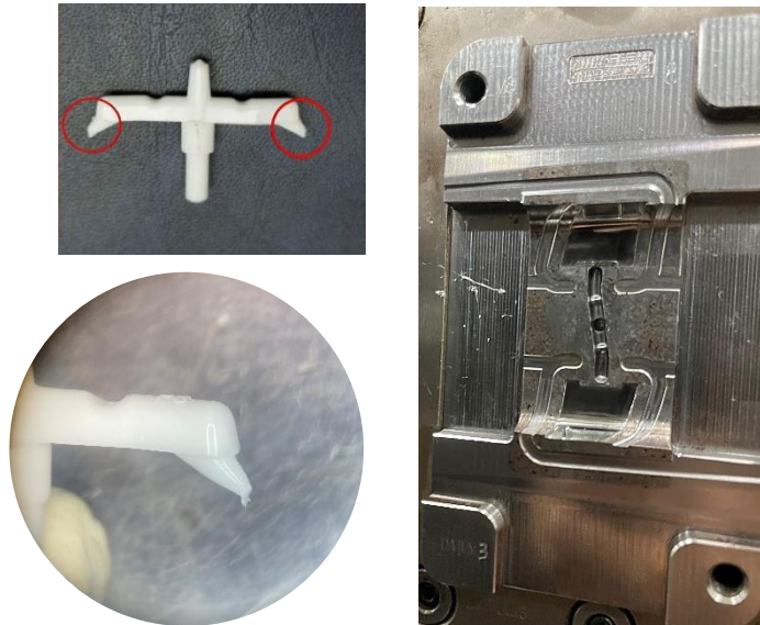
ภาพที่ 6 ลักษณะของเศษสิ่งแปลกปลอมที่ติดอยู่บริเวณผิวของแม่พิมพ์
