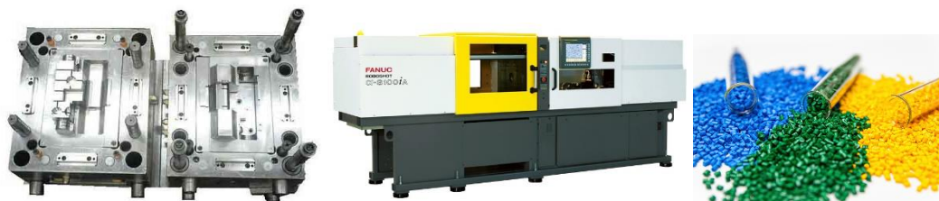
ภาพที่ 2 ตัวอย่างแม่พิมพ์พลาสติก, เครื่องฉีดพลาสติก, เม็ดพลาสติก
