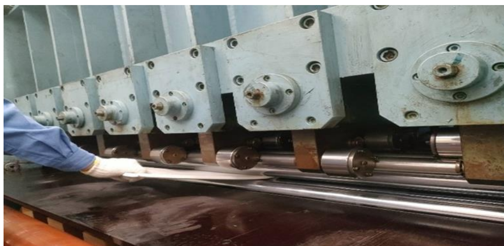
ภาพที่ 2 แสดงการล้าง Leveller Roll ที่ยังตกค้างเศษฝุ่นบนผิวโรล
