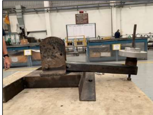
ภาพที่ 8 แบบภาพฉาย และภาพชิ้นงานจริง อุปกรณ์แขนสำหรับจับยึดชิ้นงาน
