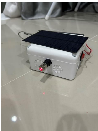
ภาพที่ 3 อุปกรณ์ Laser diode module (ซ้าย) และอุปกรณ์ Laser detect LDR (ขวา)
