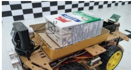
ภาพที่ 6 ตำแหน่งของกล้องเว็บแคมที่บริเวณด้านหลังเพื่อตรวจจับป้ายสินค้า
