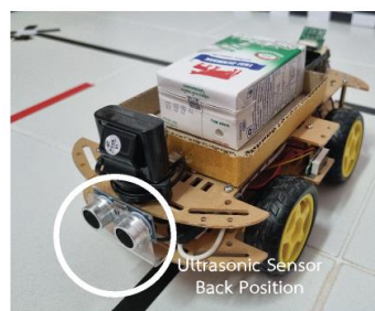
ภาพที่ 7 ตำแหน่งของเซ็นเซอร์อัลตราโซนิกส์ เพื่อตรวจจับสิ่งกีดขวาง
