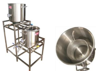
ภาพที่ 5 แสดงตัวอย่างเครื่องพาสเจอร์ไรซ์แบบ 2 ขั้นตอน
