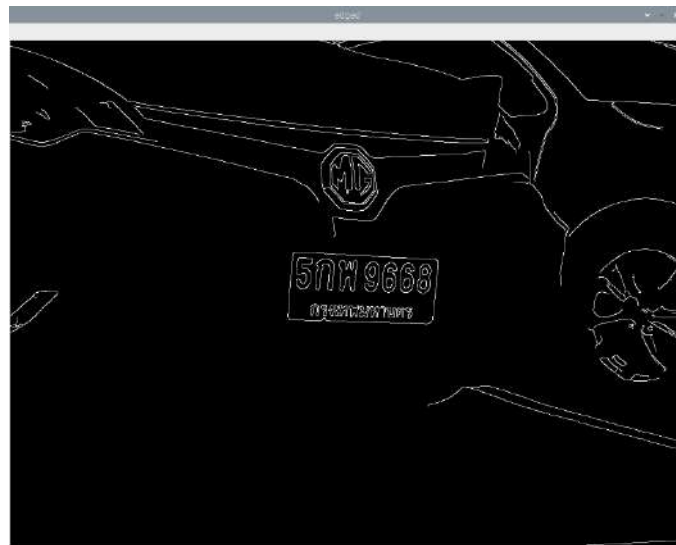
ภาพที่ 9 ตัวอย่าง การทำ CannyEdge Detection
