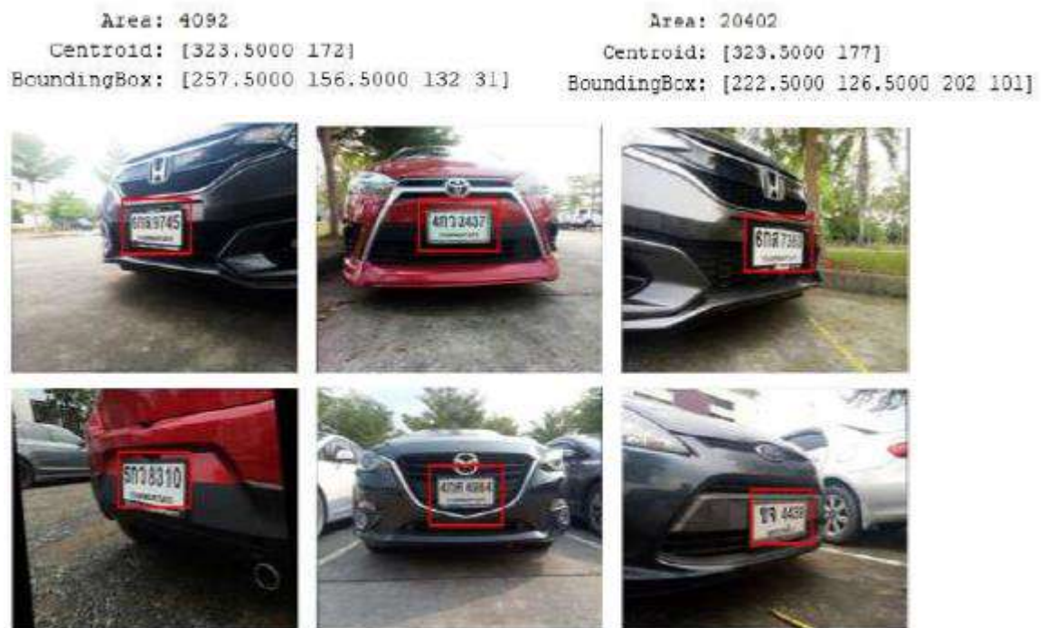
ภาพที่ 5 ผลลัพธ์ ของการหาป้ายทะเบียน เป็นรูปสี่เหลี่ยม
