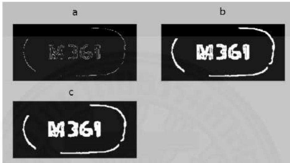
ภาพที่ 4 ผลลัพธ์ Canny edge detection ในการหาตัวอักษรของยา
