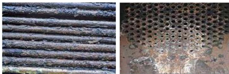
ภาพที่ 1 ตะกรันที่เกิดจากการทำปฏิกิริยา (Corrosion fouling)
