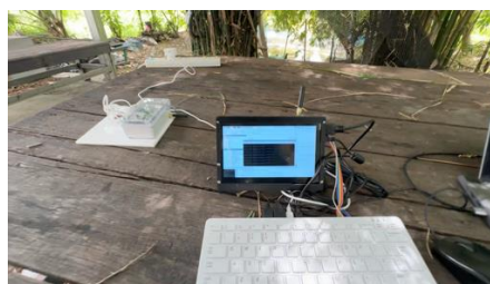
ภาพที่ 6 แสดง Raspberry Pi 400 ที่ติดตั้ง LoRa Module เพื่อเป็น LoRa Gateway
