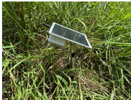
ภาพที่ 7 แสดงอุปกรณ์ Node หรือตัวอ่านข้อมูลและส่งสัญญาณ
