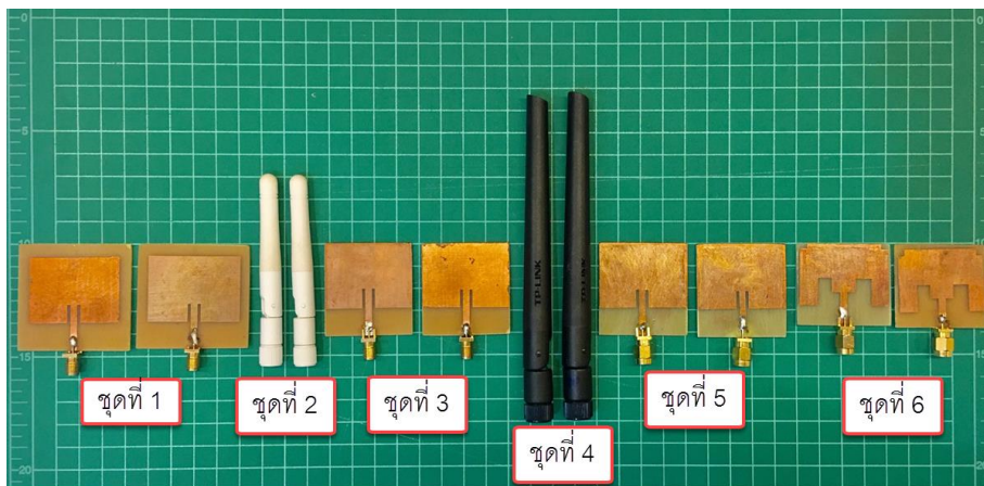
ภาพที่ 5 ชิ้นงานสายอากาศและสายอากาศสำเร็จรูปที่ใช้ทดลอง
