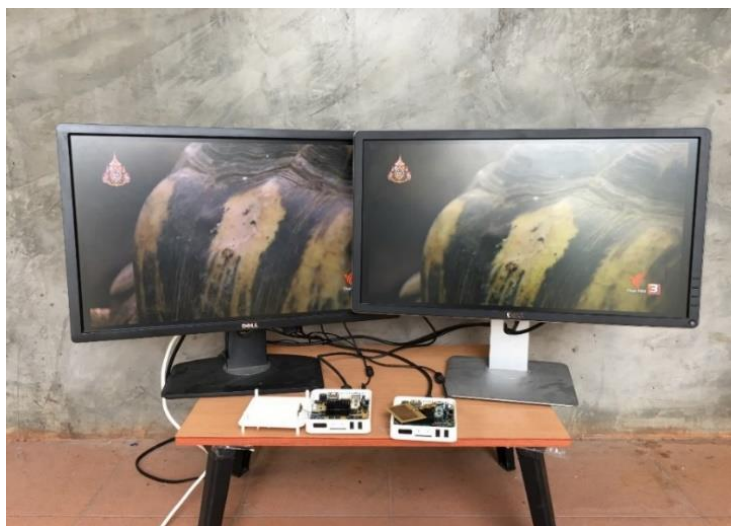
ภาพที่ 7 แสดงการทดสอบสายอากาศด้วยการรับชมช่องรายการ โทรทัศน์
