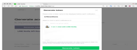
รูปที่ 5 หน้าจอแสดงวิธีการตั้งชื่อโทเคนที่ต้องการและทำการเลือก Generate token
