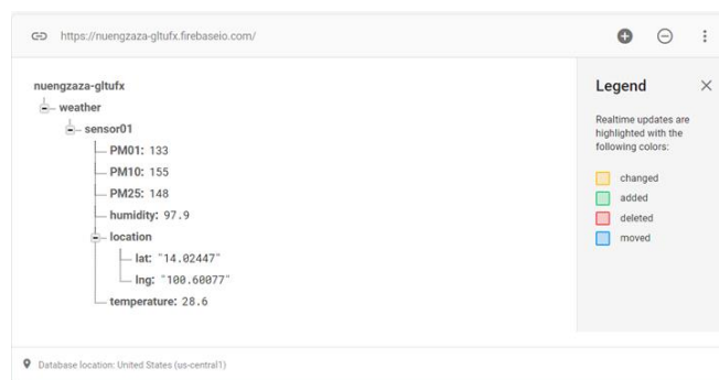
ภาพที่ 4.4 Schema ของตารางที่จัดเก็บข้อมูลใน Firebase Realtime Database ของ Google
