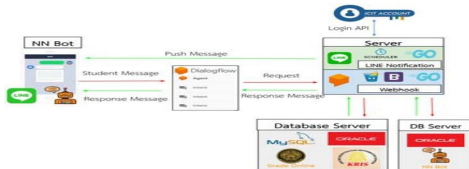
ภาพที่ 2.3 โครงสร้างของระบบ NN Bot [4]
