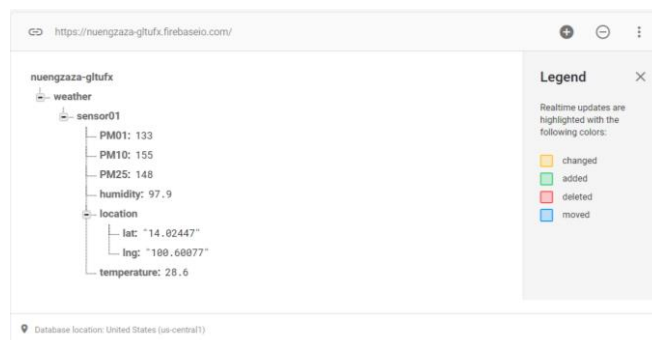
ภาพที่ 3.6 Schema ของตารางที่จัดเก็บข้อมูลใน Firebase Realtime Database ของ Google
