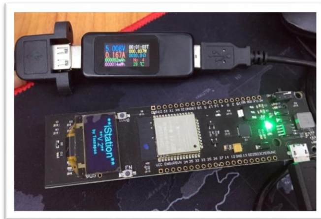
ภาพที่ 4 ภาพแสดงการทดสอบการใช้พลังงานของอุปกรณ์ BLE
