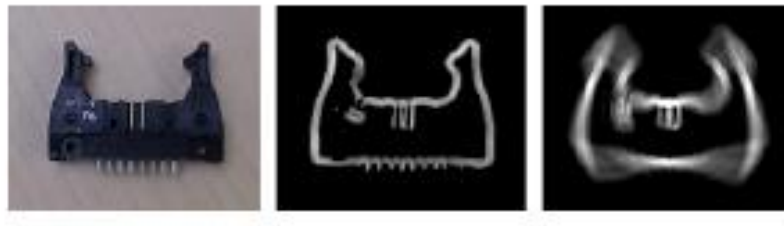
ภาพที่ 1 การสร้างรูป template ภาพต้นแบบ (ซ้าย) Gradient Image (กลาง) การสร้าง Gradient Image ในหลายทิศทาง
